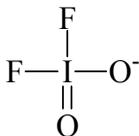
Строение  $\text{IF}_2\text{O}_2^-$  по Гиллеспи: СП = 4 (четыре  $\sigma$ -связи); НП = 1 (число неподеленных пар); СЧ = СП + НП = 5. Следовательно, пять орбиталей центрального атома иода направлены к вершинам тригональной бипирамиды. Для определения положения неподеленной пары необходимо применить дополнение Найдхоляма. Для этого нужно определить число взаимодействий неподеленной пары со связывающими парами под углом  $90^\circ$  для двух альтернативных структур:
