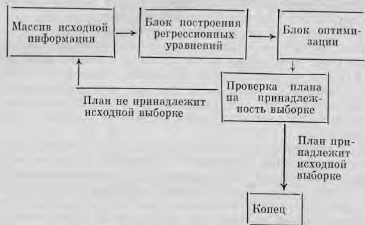
Схема 3.1. Схема проверки допустимости оптимального решения
