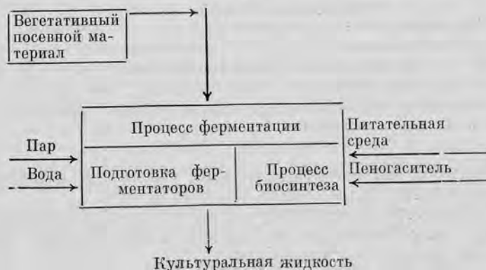
Схема 5.2. Укрупненная схема процесса ферментации
