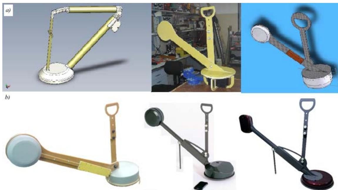
Рис. 3. Макет аппаратуры электромагнитного профилирования (а). Прототип, выполненный из листового стеклотекстолита (б)
