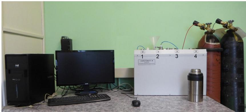
Рис. 7.9. Установка Сорбтометр-М и сопутствующее оборудование.
