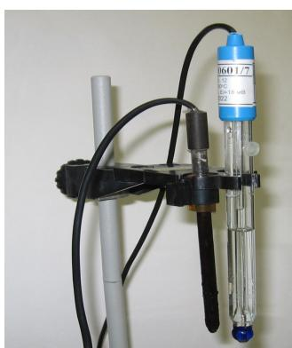
Рис. 6.11. Комбинированный электрод и датчик температуры
