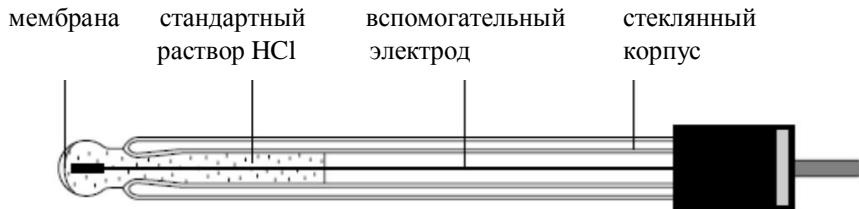
*Рис. 6.4. Устройство стеклянного электрода*
