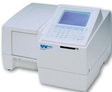
Для запуска измерения вставить кювету с анализируемым раствором в кюветодержатель и нажать клавишу START / STOP.
