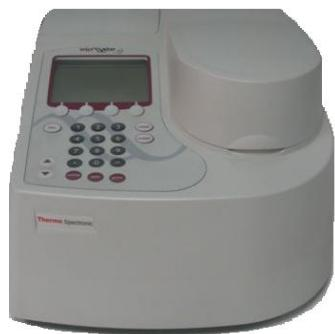
После включения сетевого выключателя (на задней панели) в течение 5 мин идёт самотестирование прибора. По окончании на экране появляется меню Utility. Если появляется иное – нажмите зелёную кнопку Utility внизу на передней панели. Проверьте установки даты и времени. Скорее всего, менять ничего не нужно.
