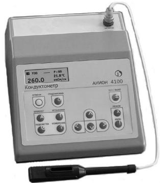
Рис. 5.3. Внешний вид кондуктометра «Анион 4120»
