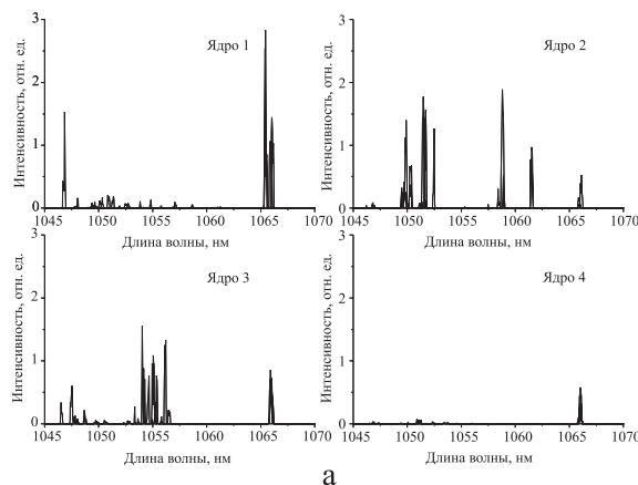
Рис. 4. Спектр генерации лазера: а – до нанесения геля с показателем преломления, как у стекла; б – после нанесения. Мощность накачки 3,8 Вт
