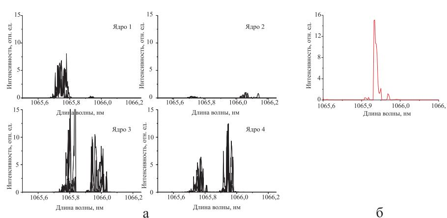
Рис. 5. Спектр генерации лазера после склейки с решеткой. Мощность накачки 3,8 Вт. Разрешение спектроанализатора 0,02 нм
