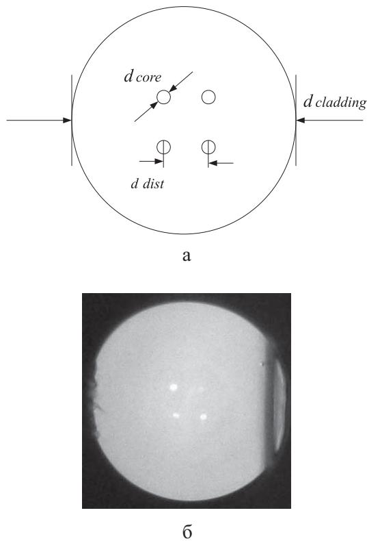
Рис. 1. Четырехсердцевинное волокно: а – модель; б – фотография
