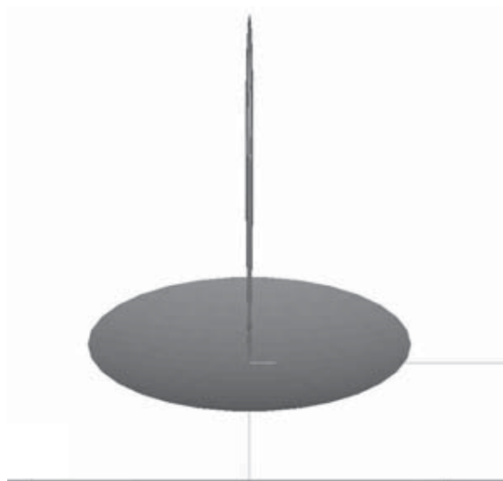
Рис. 6. Геометрия модели параболического рефлектора
