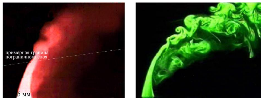
Рис. 16. Визуализация дымом струи в пограничном слое при K = U_{\text{струи}} / U_{\infty} \approx 3 в настоящем эксперименте (слева) и визуализация струи в пограничном слое в водяном канале при K = U_{\text{струи}} / U_{\infty} \approx 3,5 из работы [30] (справа)
