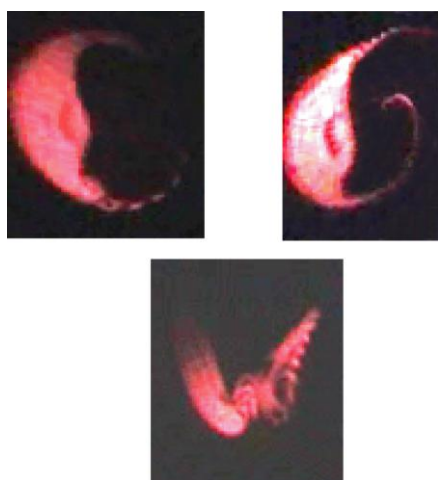
Рис. 11. Картины дымовой визуализации поперечного сечения струи, подверженной вторичной высокочастотной неустойчивости при акустическом воздействии на нее
