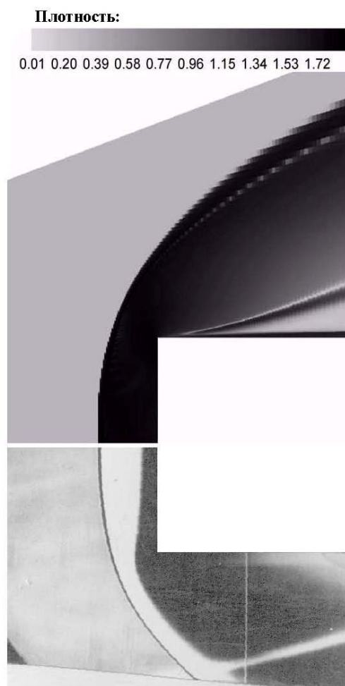
Рис. 10. Сравнение расчетной (вверху) и экспериментальной (внизу) газодинамической структуры течения, реализующейся в окрестности продольно обтекаемого цилиндра нием \lambda = 0,6 \div 12,0 в диапазоне углов атаки \alpha = 0 \div 90^\circ при числе M_\infty = 4 . Полученные
