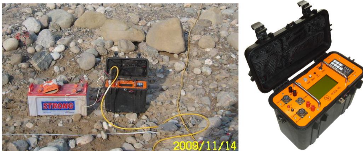
Рис. 4. Внешний вид аппаратуры «Скала-48».
