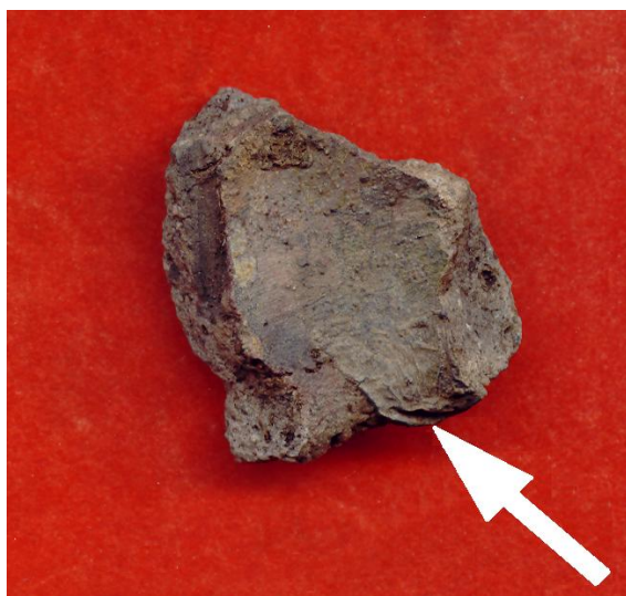
Рис. 9. Внутренняя сторона того же фрагмента венчика тигля с застывшим потеком меди – показан стрелкой (увеличено)
