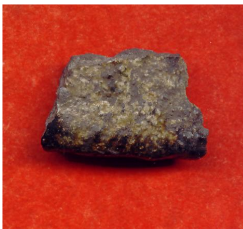
Рис. 5. Фрагмент тигля с сильно оплавленным венчиком – вид со стороны венчика (макросъемка, без масштаба)
