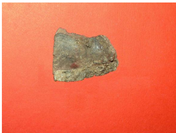
Рис. 7. Фрагмент оплавленной внутренней стенки тигля, окрашенной в разные цвета (макросъемка, без масштаба)
