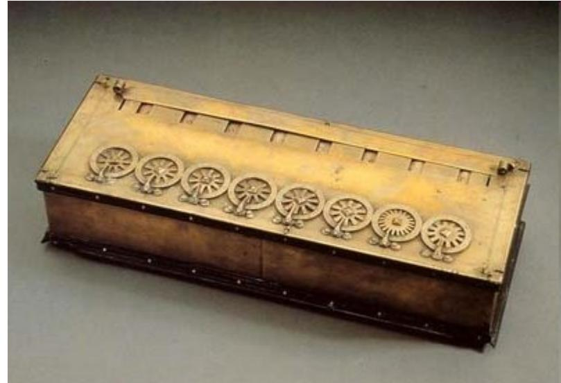
Счетная шестерня при помощи храпового механизма (передающего прямое движение и не передающего обратного) соединялись с рычагом. Отклонение рычага на тот или иной угол позволяло вводить в счетчик однозначные числа и суммировать их. В машине Паскаля храповой привод был присоединен ко всем счетным шестерням, что позволяло суммировать и многозначные числа.
