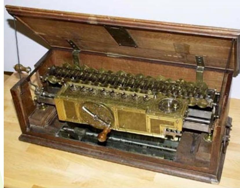
Изделие Лейбница постигла печальная судьба предшественников: массового спроса на подобные механизмы еще не пришло. Машина являлась прототипом арифмометра, использующегося с 1820 года до 60-х годов XX века.
