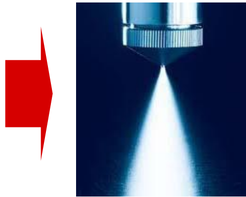
Распыление раствора в емкость с жидким азотом ( P_{изб.} \sim 1 атм., d_{капилляр} \sim 0.4 мм.)
