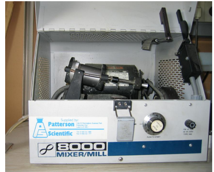
Шаровая мельница SPEX 8000 (США), 10 г.
