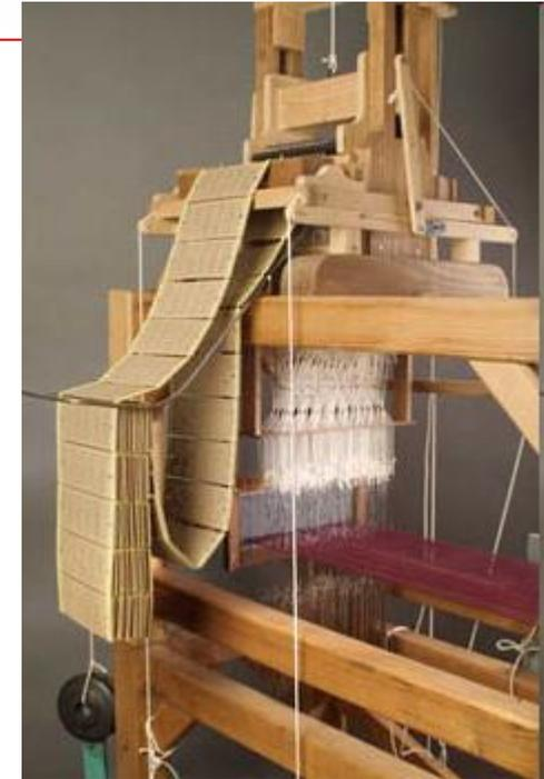
Создание ткацкого станка, управляемого картами с пробитыми на них отверстиями и соединенные друг с другом в виде ленты, относится к одному из ключевых открытий, обусловивших дальнейшее развитие вычислительной техники.
