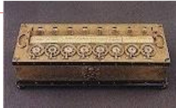
Счетная шестерня при помощи храпового механизма (передающего прямое движение и не передающего обратного) соединялись с рычагом. Отклонение рычага на тот или иной угол позволяло вводить в счетчик однозначные числа и суммировать их. В машине Паскаля храповой привод был присоединен ко всем счетным шестерням, что позволяло суммировать и многозначные числа.
