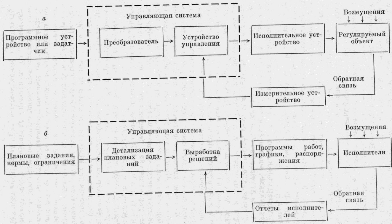
Схема 1.2. Система автоматического регулирования (а) и ее аналог в организации (б).
