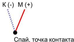
*Рис. 1.1. Термопара медь – константан (тип Т)*
