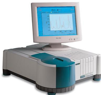
измерения времени регистрации спектра (мин), предельное значение оптической плотности (1.0) и способ записи кинетики (Simple collect). Задайте продолжительность эксперимента (5 мин).
